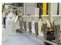
rampe de filtration
