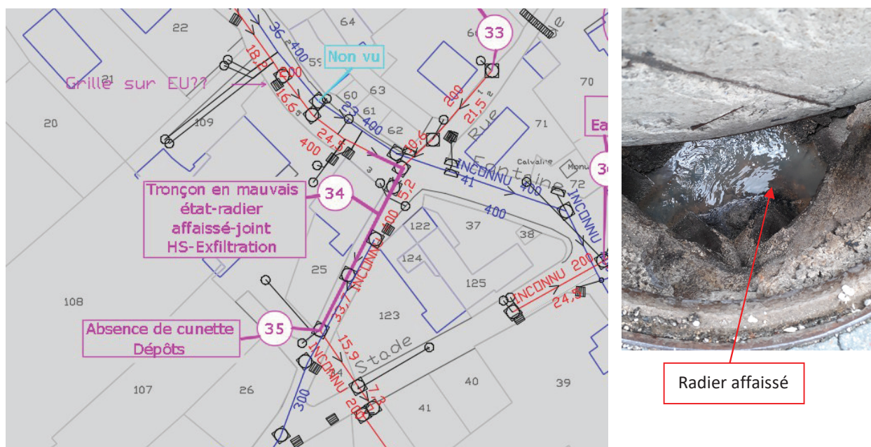
Figure 17 : Tronçon en mauvais état - Rue de la Fontaine
