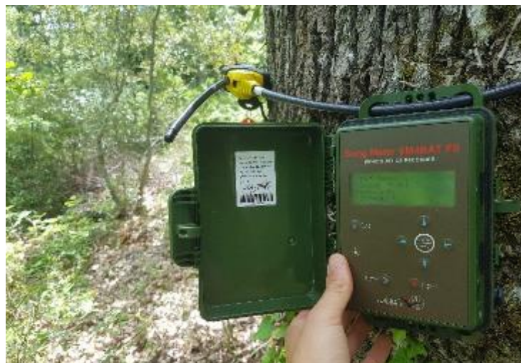
PARAMETRAGE DU SM4BAT SUR LE TERRAIN ©J. COSTA
