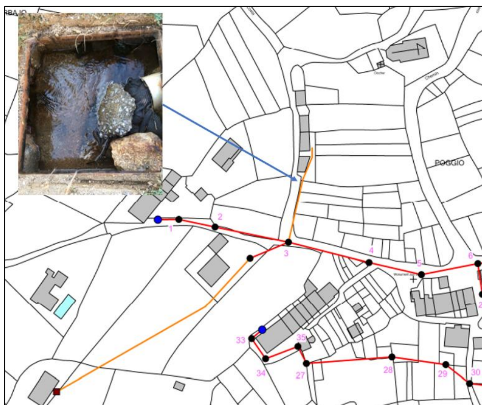
Illustration 8 : Intrusion d'ECP via un branchement non étanche
