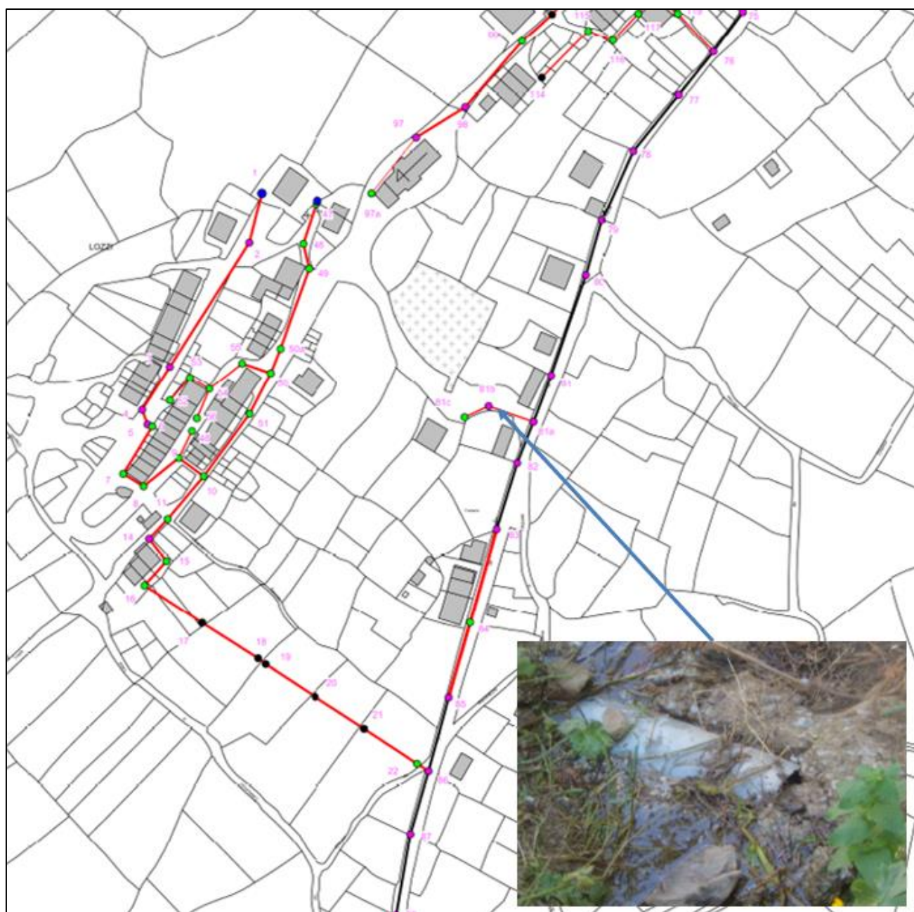
Illustration 7 : Défaut d'étanchéité du réseau d'assainissement entre R81a et R81b
