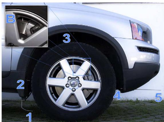
Figure 14 : Position des tubes d'échantillonnage (Mathissen et al. 2011).
