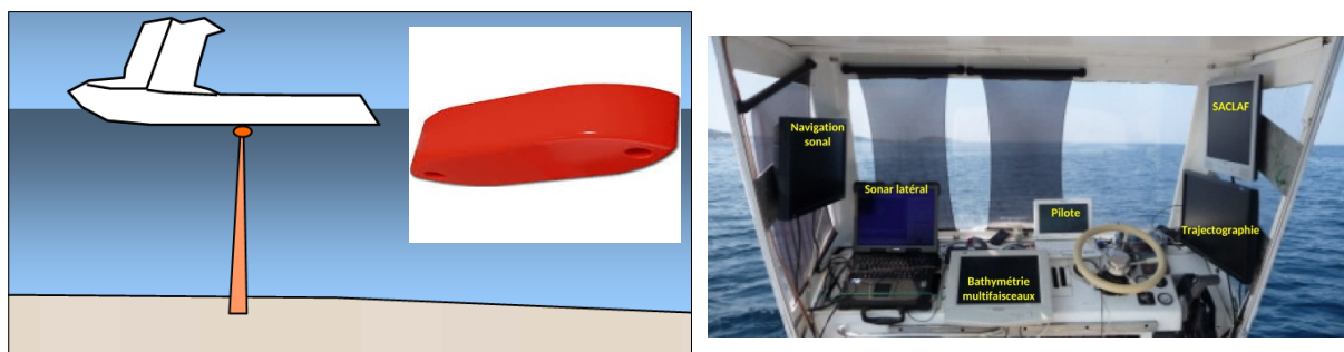
Figure 4 : A Gauche : Principe d'acquisition d'un sondeur multi-faisceaux & céramique 38/200kHz A droite : Poste de pilotage du navire océanographique
