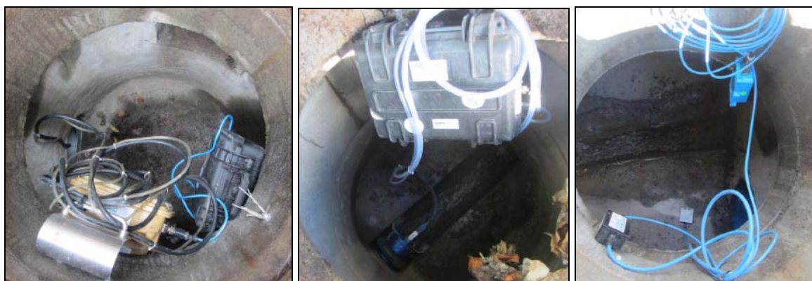
Débitmètres utilisés (sigma 950, bubbleflo et détecteur de surverse)
