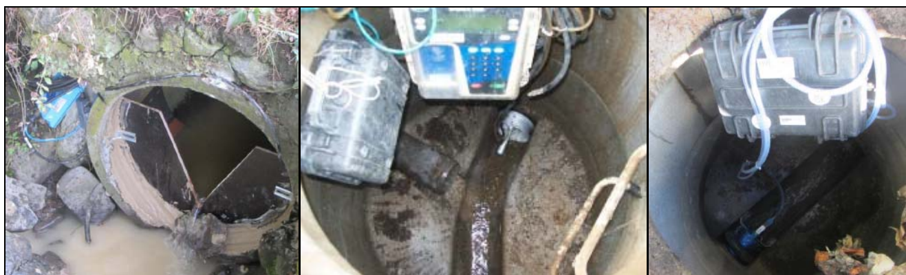
Débitmètres utilisés (sonde piézométrique et vista+, sigma 950, bubbleflo)
