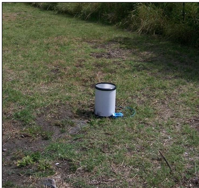
Pluviomètre avec enregistreur Vista+
