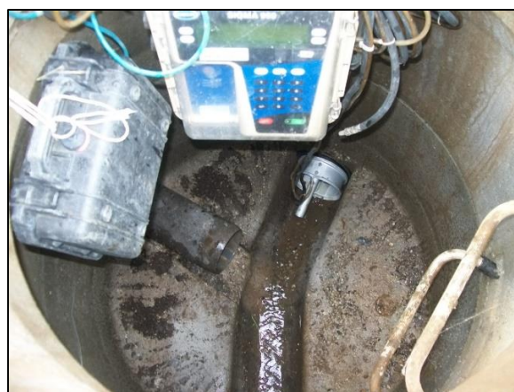
Débitmètre SIGMA 950 avec manchon déversoir
