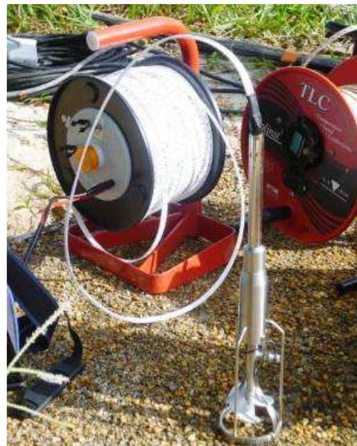
Figure 41 : Fluxmètre SEBA Mini Current M1
