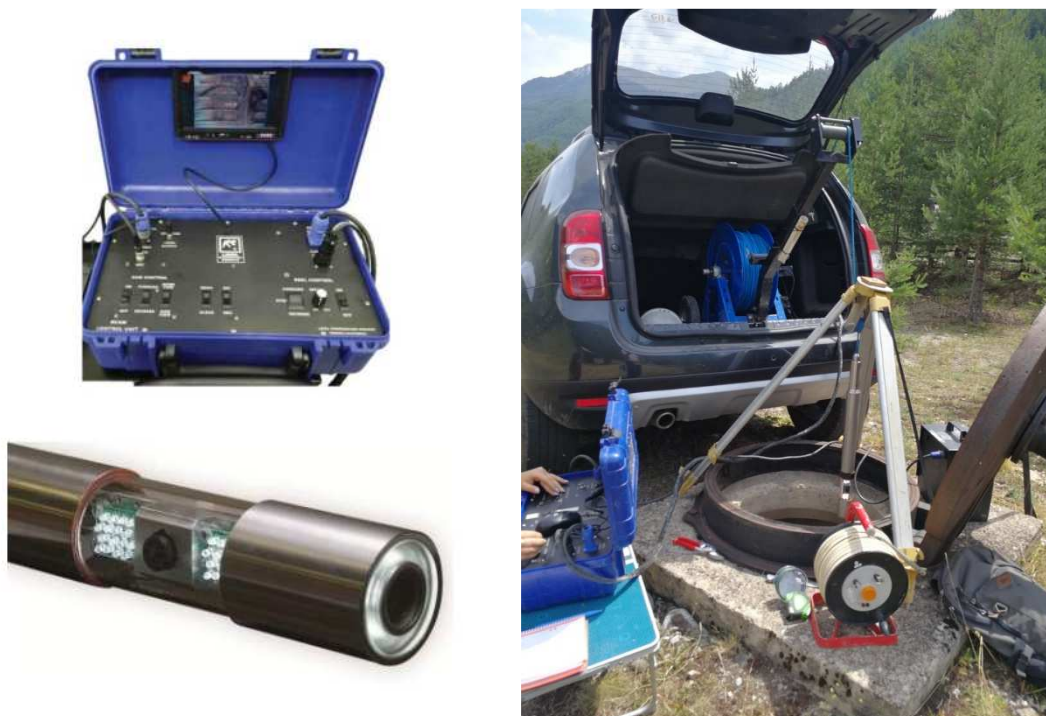
Figure 7 : caméra mise en œuvre pour l'inspection du forage (LAVAL RC CAM 1000 XS)
