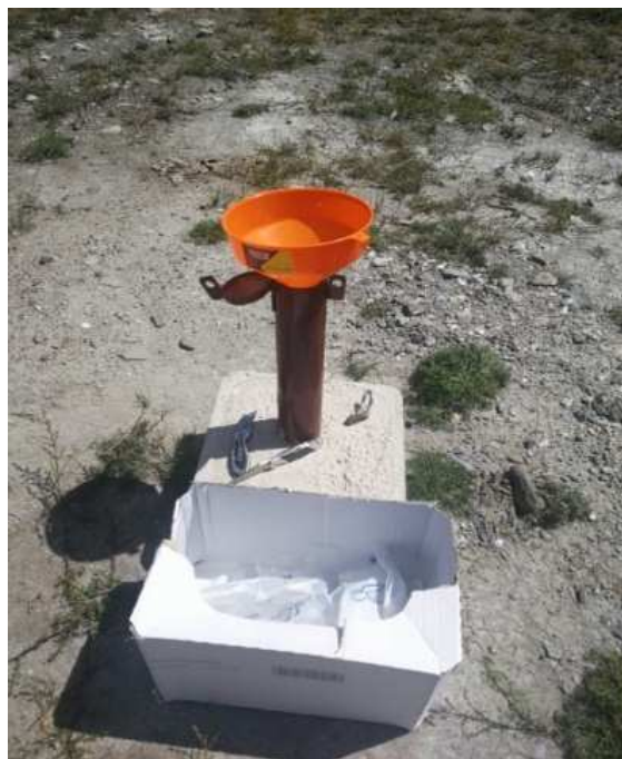
Figure 45 : Injection NaCl dans PZ1
