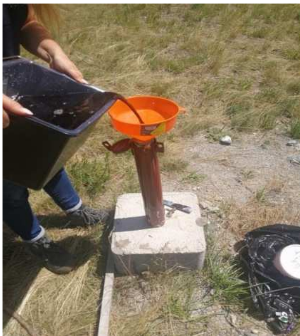
Figure 47 : Injection Naphtionate dans PZ2
