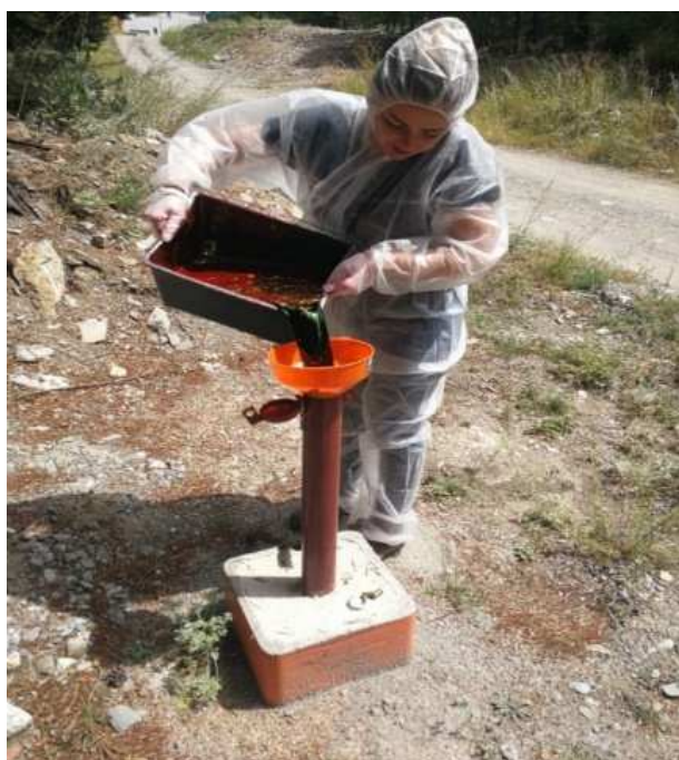
Figure 47 : Injection fluorescéine dans PZ4
