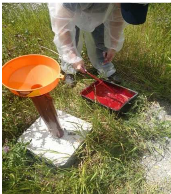
Figure 45 : Injection Sulforhodamine dans PZ3
