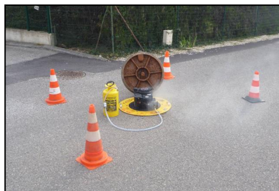
Figure 20 : Photographie de l'injection de fumée dans les réseaux
