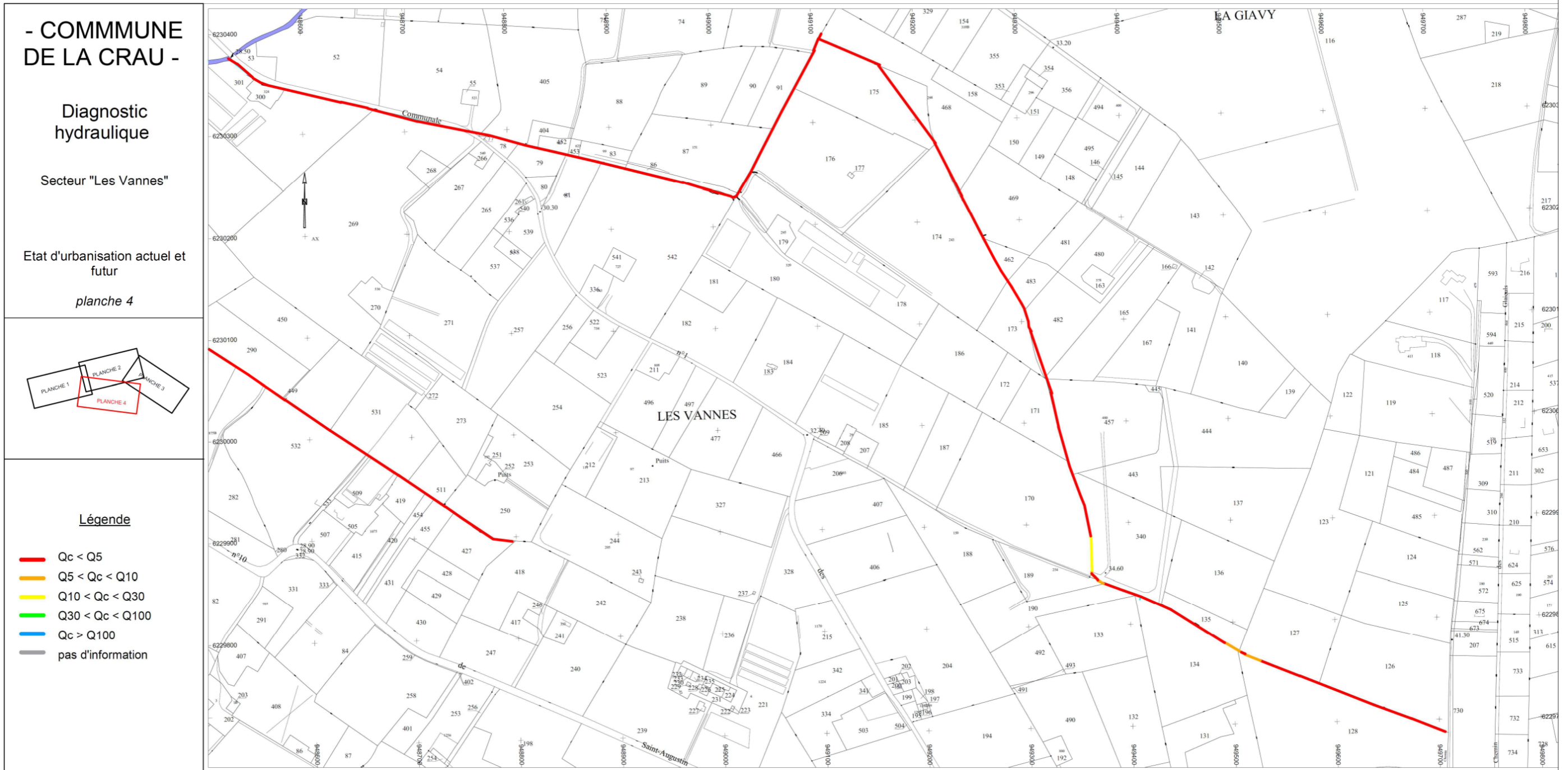
Figure 29 : Diagnostic hydraulique - Les Vannes - planche 4/4
