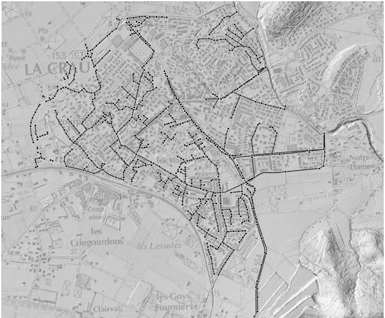
Figure 53 : Réseau pluvial sous hydra
