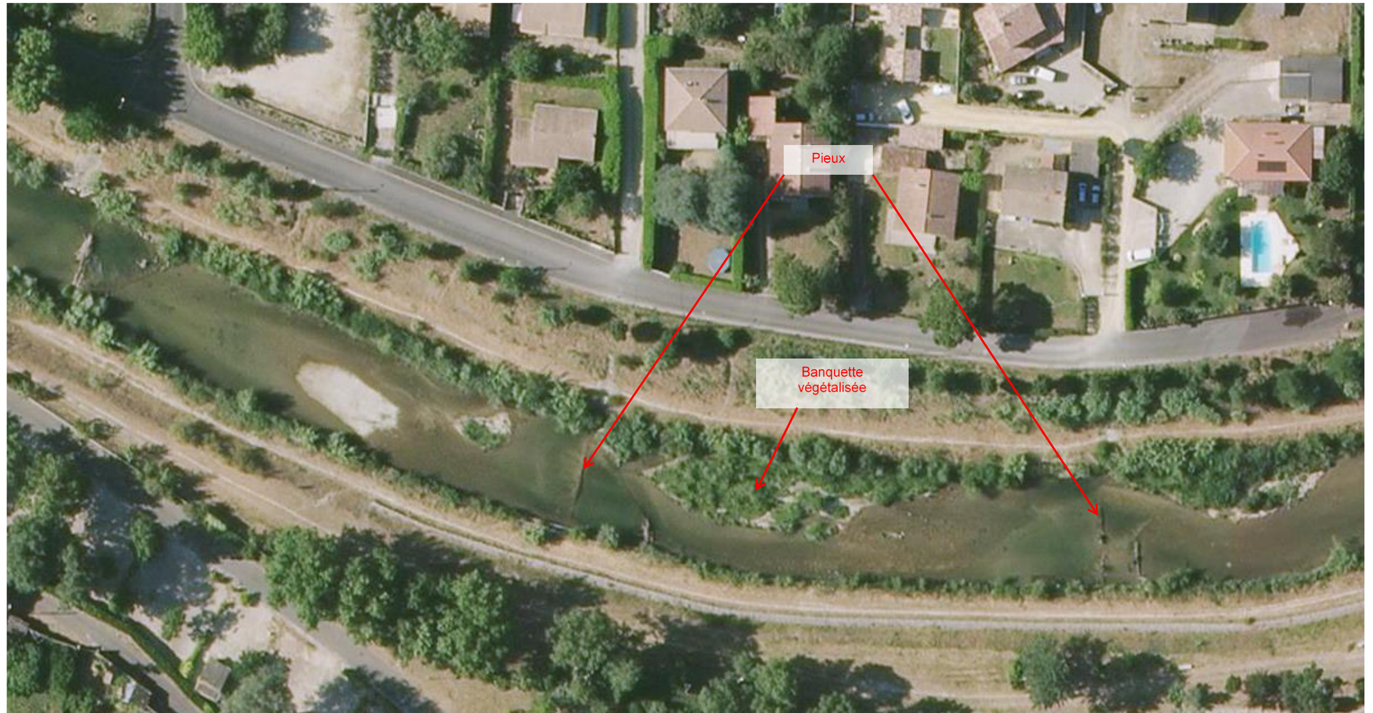
Epis déflecteurs actuels (pieux en bois) et plages végétalisées à l'amont du pont de Chabrières : Aménagement de même type que le projet à l'aval du pont
