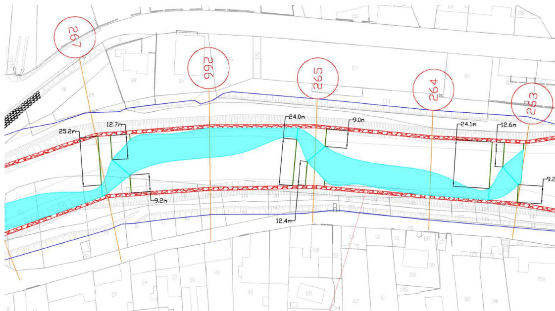
Extrait du plan général des déflecteurs sur le Lez en aval du pont de Chabrières (Hydrétudes)
