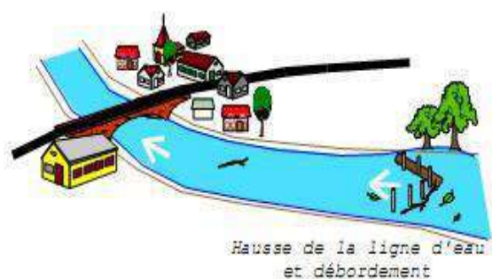
Figure 36 : Fonctionnement du piège à embâcle (source : CEMAGREF, 2002)
