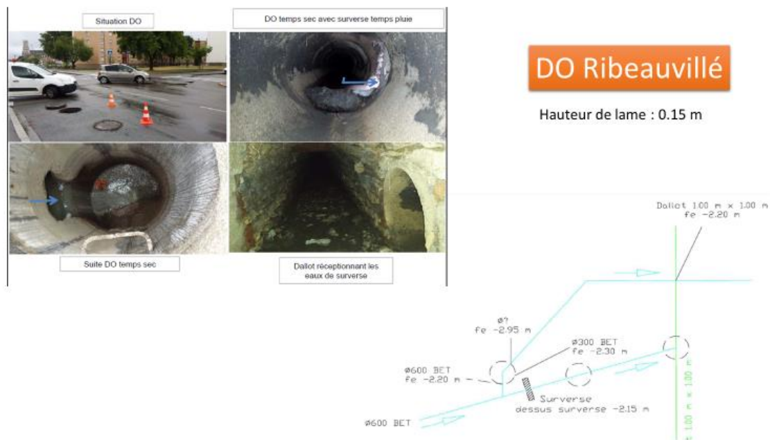
Figure 71 : Photos et schéma du déversoir d'orage Ribeauvillé
