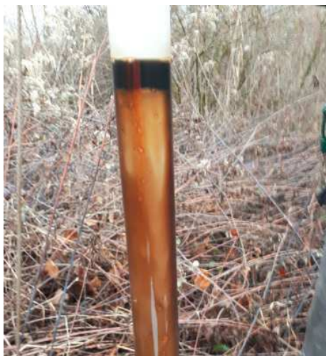
Figure 6 : Flottant (hydrocarbures) au sein du PZ2 (prélèvement à l'aide d'un bailer)
