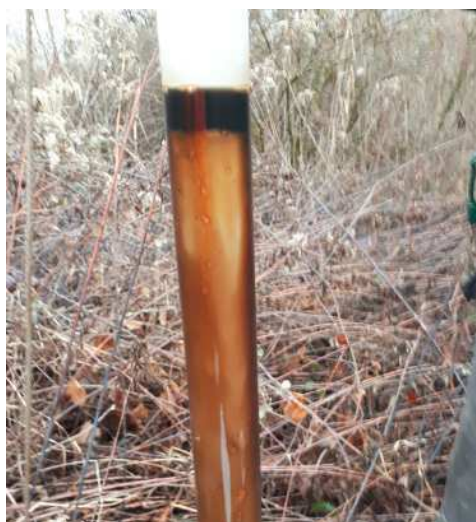
Figure 5 : Flottant (hydrocarbures) au sein du PZ2 (prélèvement à l'aide d'un bailer)
