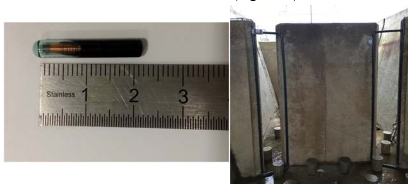
Figure 7 : Exemple de Pit-Tag de 23 mm (Source : MRM) et d'une antenne de détection (Source : profish)
