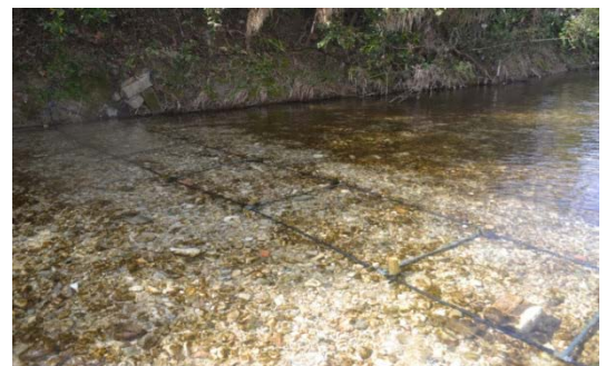
Figure 2 : L'une des 2 antennes fixes du site de Bugadières
