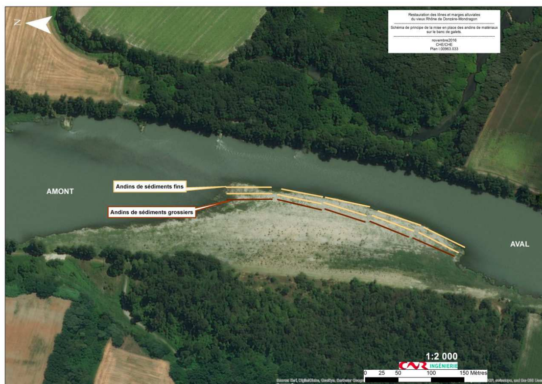
Figure 70 : Schéma de principe de la mise en œuvre des andins sur le site des Dames
