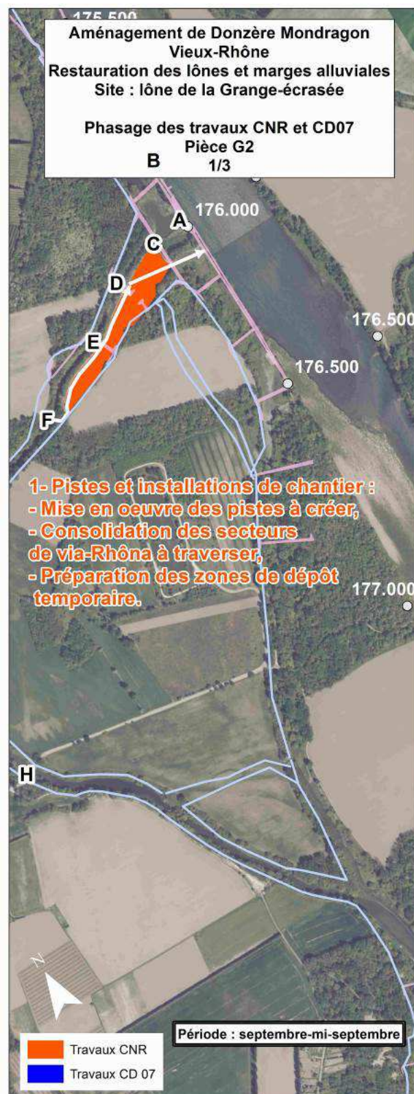
I-Installations de chantier et création de piste
