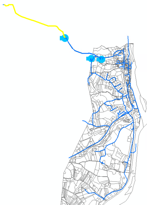
Figure 3 : Cartographie des priorités de renouvellement – canalisations d'adduction
