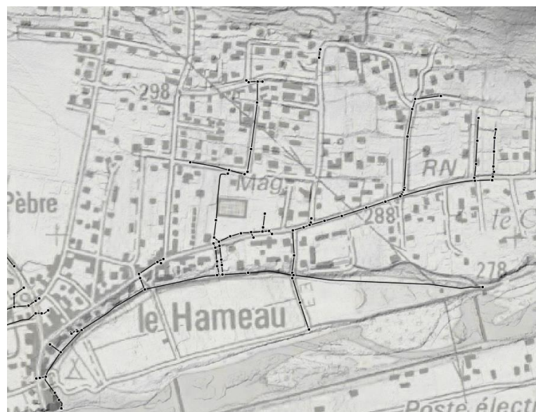
Figure 37 : Réseau pluvial sous hydra
