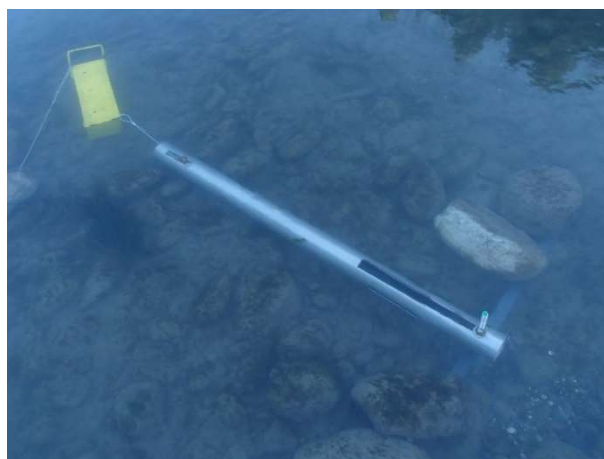
Planche photographique 2 : dispositif de mesures in situ. La sonde est protégée par un tube en acier inoxydable largement ajouré au niveau de la crépine. Les capteurs sont surélevés d'environ 25 cm par rapport au fond pour limiter la problématique de colmatage.
