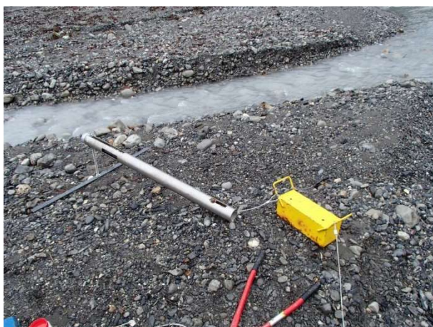
Planche photographique 2 : dispositif de mesures in situ. La sonde est protégée par un tube en acier inoxydable largement ajouré au niveau de la crépine. Les capteurs sont surélevés d'environ 25 cm par rapport au fond pour limiter la problématique de colmatage.
