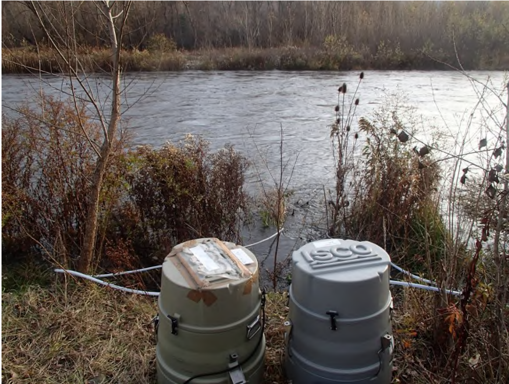
Photo 7: ISCO installés en bordure du cours d'eau
