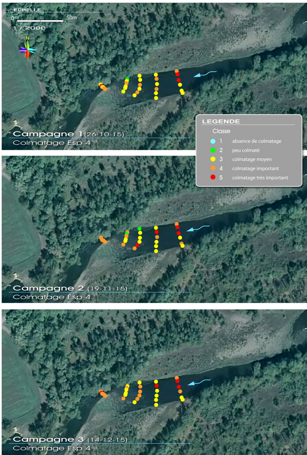
Figure 34 : Résultat du suivi du colmatage Archimbaud (Enchâssement) sur la station ESP4 ; fond de carte 2015
