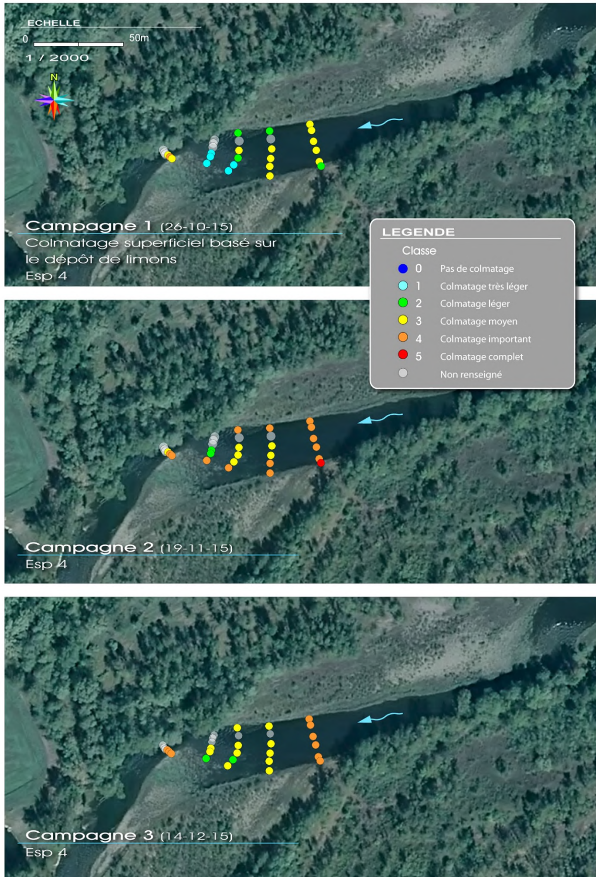
Figure 33 : Résultat du suivi du colmatage superficiel (dépôt de limons) sur la station ESP4 ; fond de carte 2015
