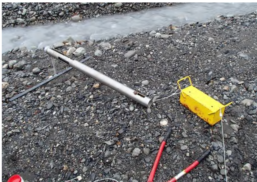
Photo 9 : Dispositif de pose des sondes enregistreuses - La sonde est protégée dans le tube, retenue en amont par un lest et relevée vers l'aval par un pied - L'ensemble est sécurisé par un câble en acier de 3 mm
