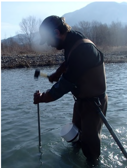
Photo 8: Mise en œuvre du protocole d'évaluation du colmatage interstitiel « Datry » – Photo gauche : Enfoncement du piézomètre dans le substrat, Photo droite : Infiltration du volume d'eau dans le piézomètre
