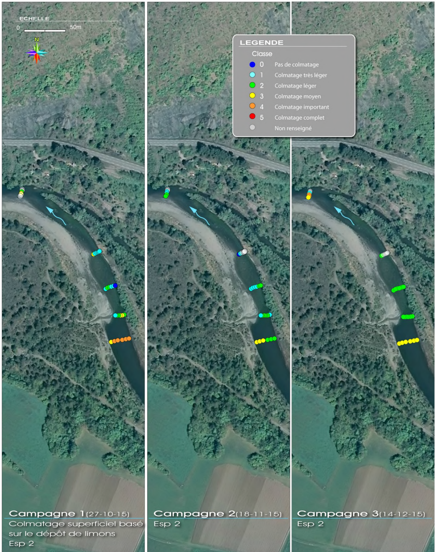
Figure 27 : Résultat du suivi du colmatage superficiel (dépôt de limons) sur la station ESP2 ; fond de carte 2015
