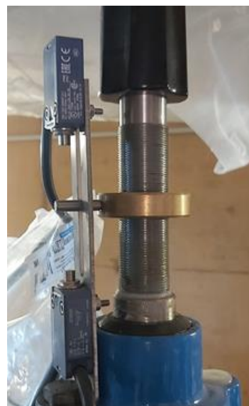
Figure 3-1: Principe de fins de course pour modules à masque motorisé
