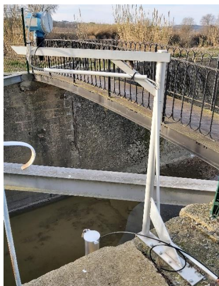
Figure 3-2 : Principe de mesure radar sur potence
