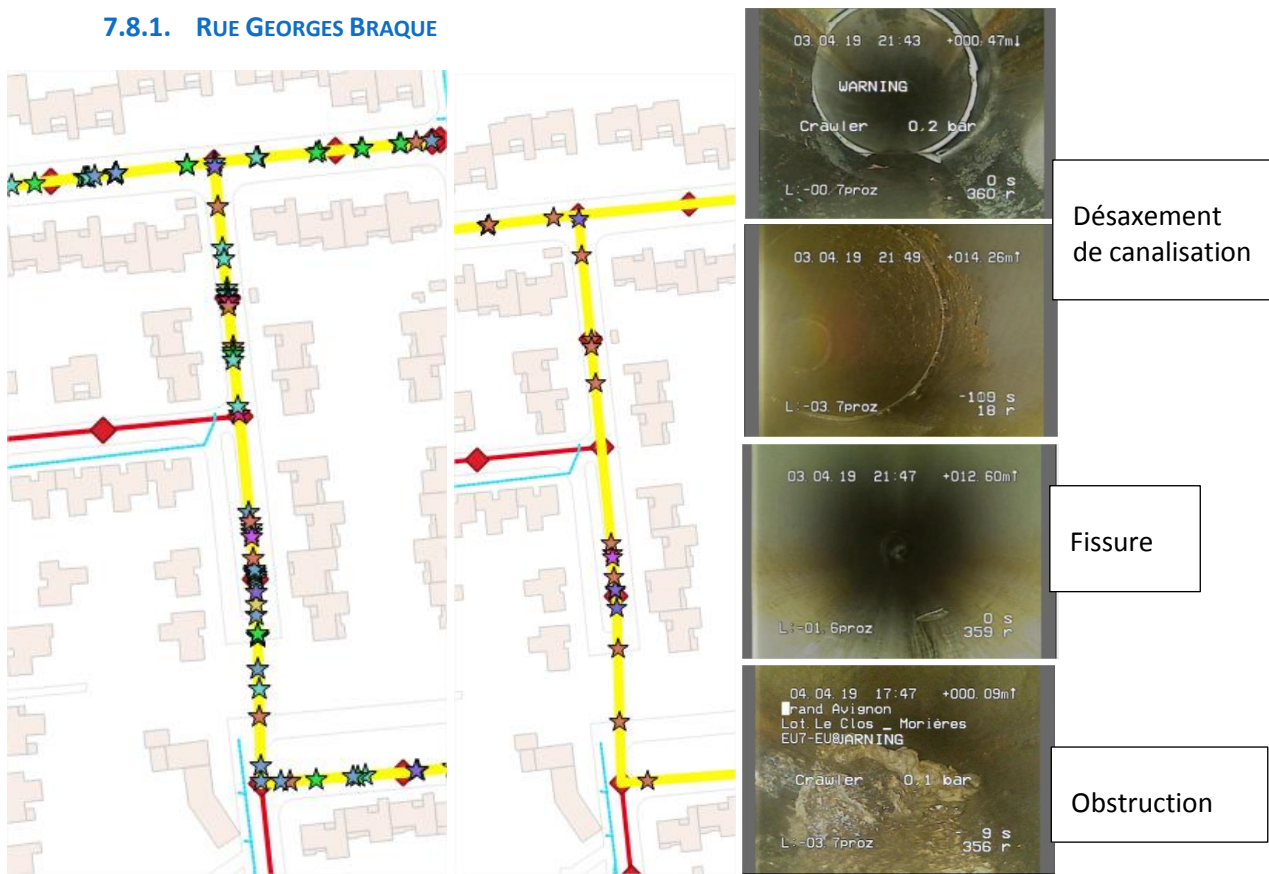
Fig. 75. ITV Rue Georges Braque (toutes anomalies reperées à gauche et anomalies de catégories 1/2/3 à droite)
