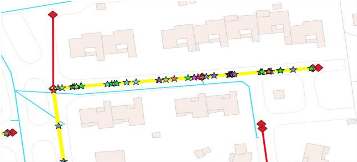
Fig. 71. Zone ITV rue Pierre Bronnard (toutes anomalies repérées)
