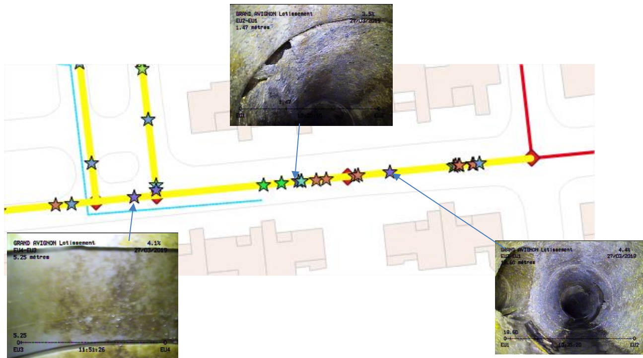
Fig. 70. Zone ITV rue Pierre Bonnard (toutes anomalies repérées)
