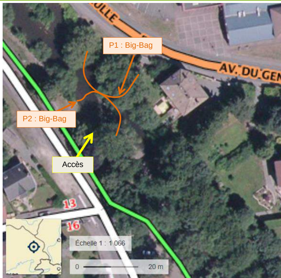
Fig. 34. Points de mise à sec de la zone de chantier à l'ouvrage ROE55862
