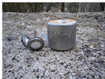
Exemple de capteurs passifs exposés dans la Bienne, ici les membranes POCIS et leur dispositif de protection
