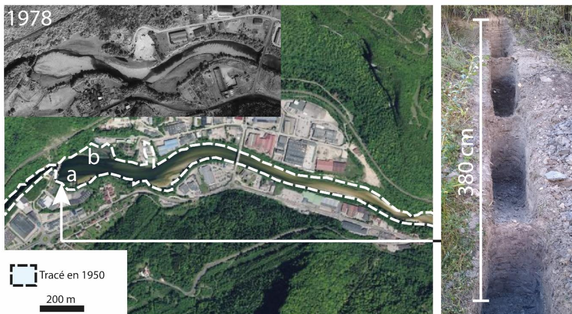
FIG. 10 : EVOLUTION DU TRACÉ DES BERGES DU RESERVOIR D'ETABLES. LA PHOTOGRAPHIE AERIENNE EN COULEURS DATE DE 2017. LES DESIGNATIONS A ET B MONTRENT DES ZONES D'ACCUMULATION DE SEDIMENTS FINS DEJA VISIBLES LORS DE LA VIDANGE DE 1978
