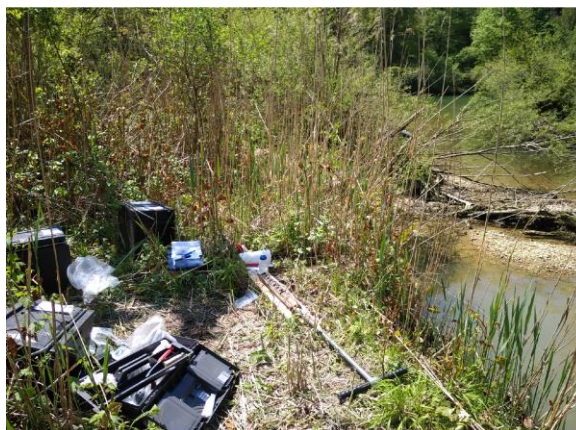
Carottage à l'aide d'un carottier russe en sommet de berge au niveau de la station en aval de Dortan
