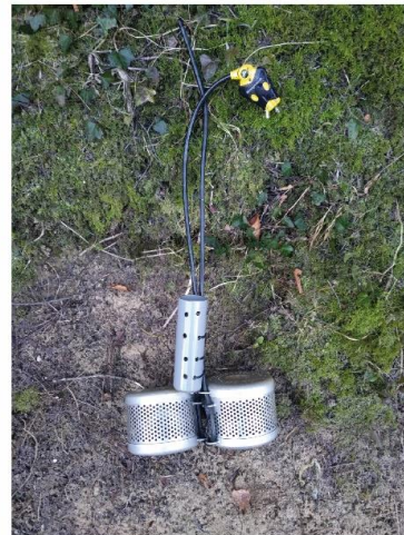
Dispositif permettant l'exposition des capteurs passifs
