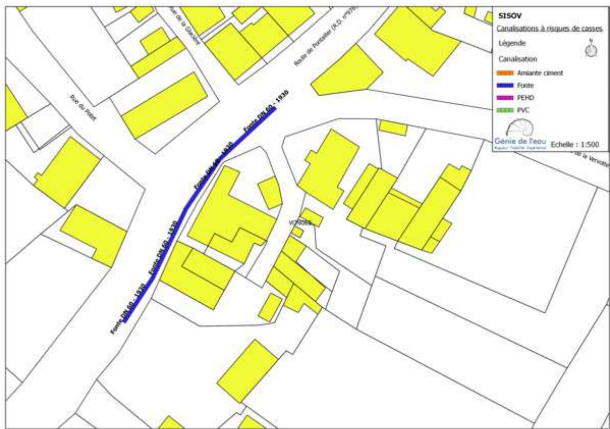
Figure 51 : Identification des canalisations en fonte à risques de casse sur le secteur de VONGES
