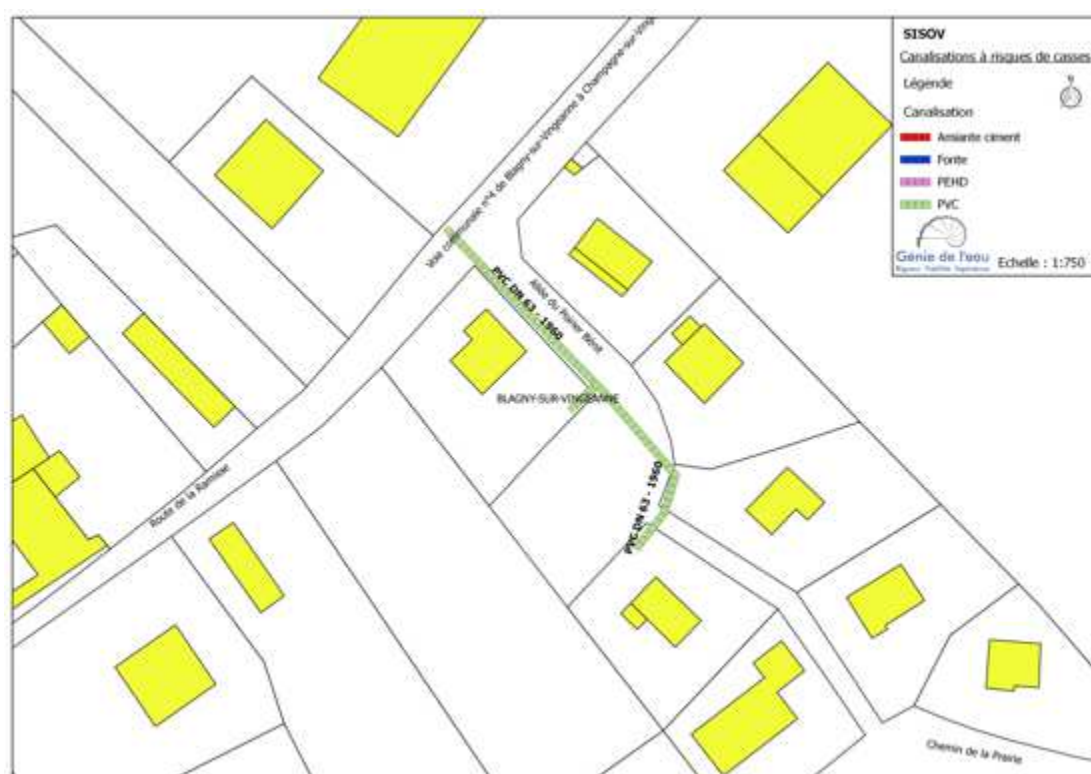
Figure 55 : Identification des canalisations en PVC à risques de casses sur le secteur de BLAGNY SUR VINGEANNE
