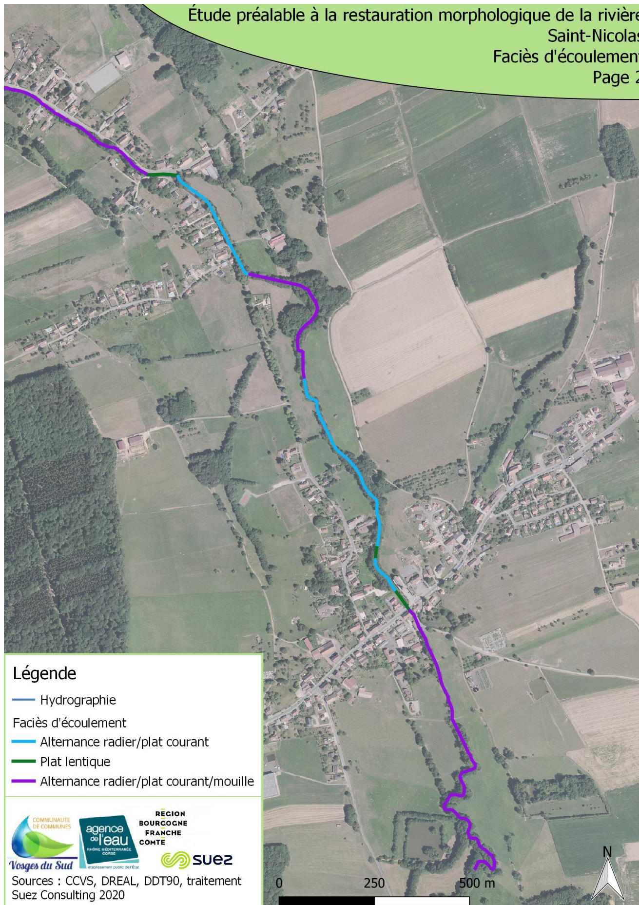
Figure 47 : Faciès d'écoulement par tronçon homogène
