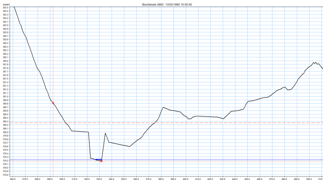
Figure 39 : Vue du profil en travers 16 de la rivière Saint-Nicolas en crue biennale. La ligne rouge marque la hauteur d'eau maximale
