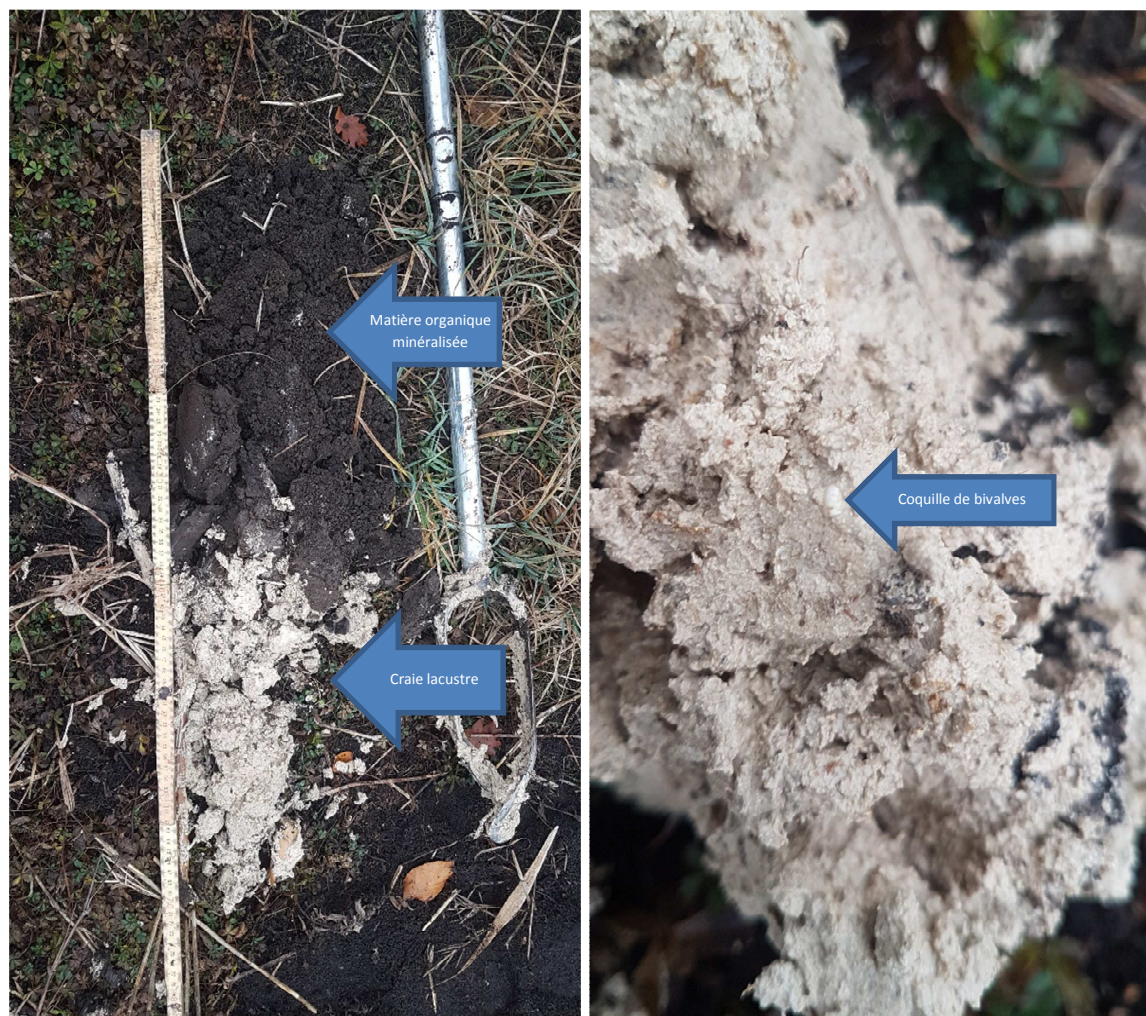
Figure 3.10 : sondage pédologique juste à l'amont de la perte (à gauche : détail avec la présence de coquillages)
