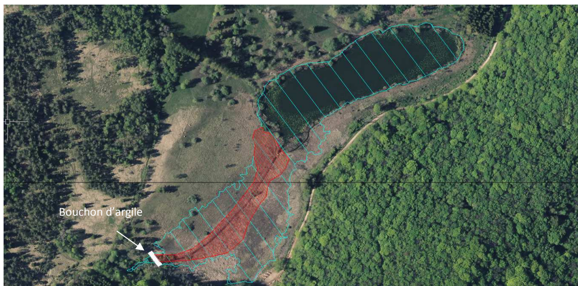
Figure 3.14 : mise en place d'un bouchon d'argile vers les pertes avec la cote d'eau future probable en bleu et la surface à régaler en rouge.
