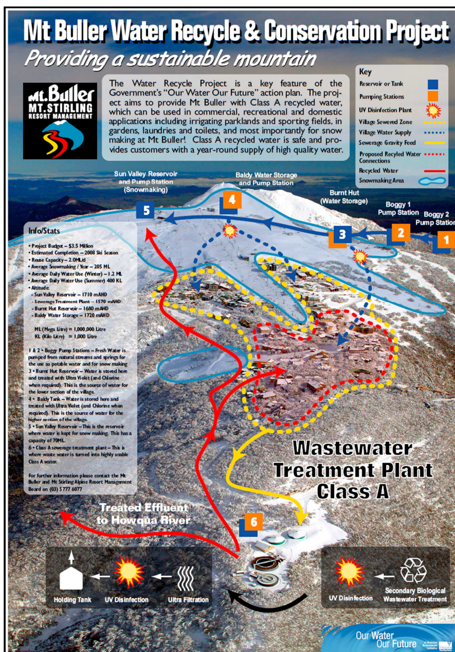
Figure 4 : Carte du recyclage et du traitement de l'eau usée pour la production de neige au Mont Buller (Australie)
