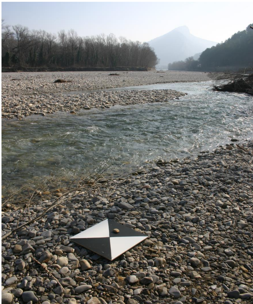
Figure 7. Cible de 40x40cm utilisée comme GCP
