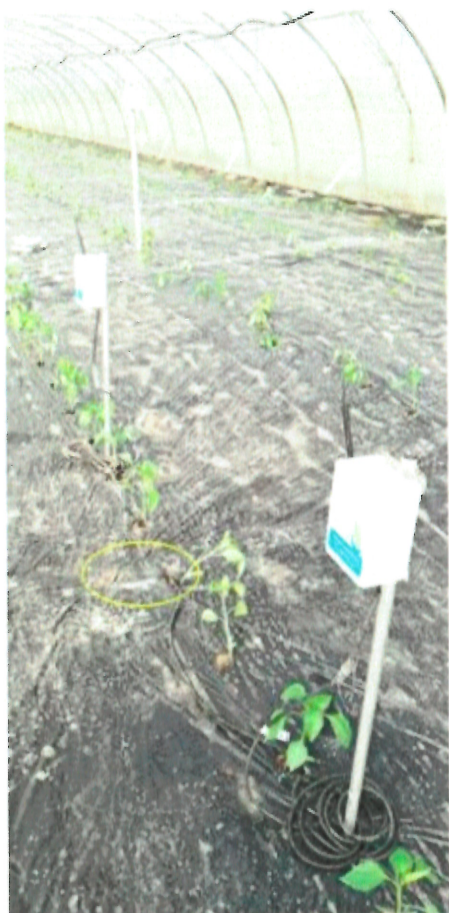
Figure 6 : Emplacements des boîtiers de transmission et sondes capacitive.
