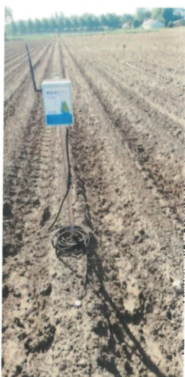
Figure 17 : compteur connecté Solem et prise de pression sur une canne d'asperseur (2019)
