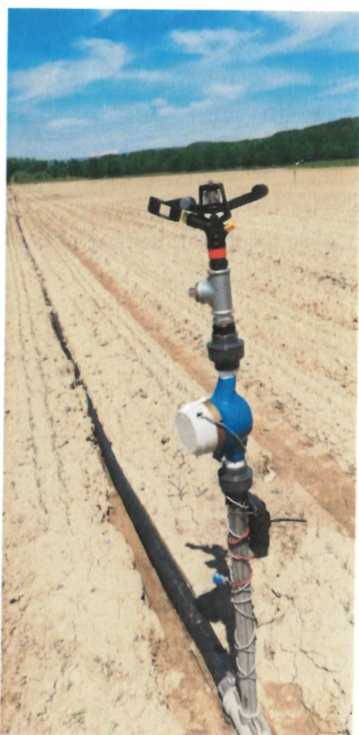
Figure 17 : compteur connecté Solem et prise de pression sur une canne d'asperseur (2019)
