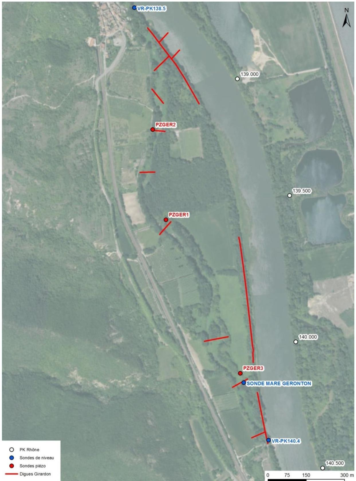
Figure 8 : Localisation des sondes de niveau et des piézomètres.
