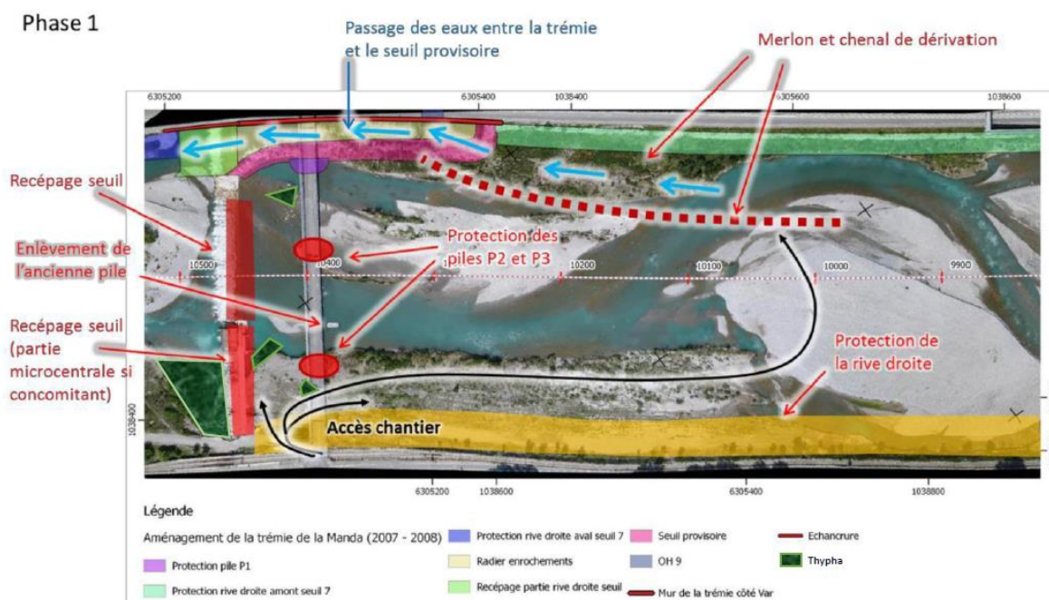
Figure 21 : Phase 1 des travaux envisagés
