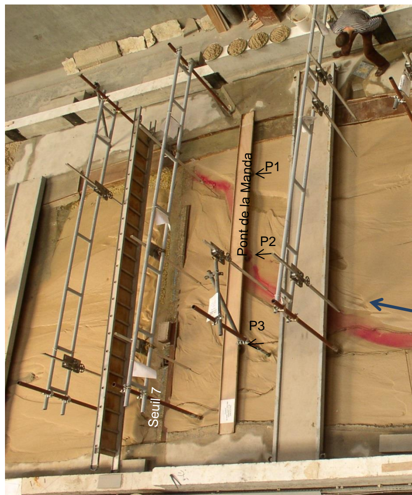
Figure 34 : Essai 3 du modèle physique à fonds mobiles de la trémie de la Manda (enlèvement du seuil provisoire) : chenaux à la fin de la crue centennale (source : /11/)
