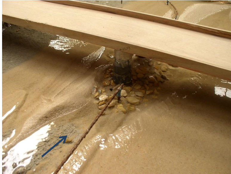
Figure 76 : Protection de la pile P3 au cours des essais de la configuration finale (source : SOGREAH, archives de l'étude /11/)
