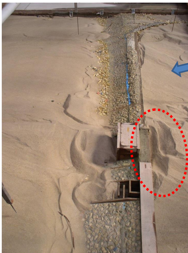
Figure 74 : Affouillement en amont de la microcentrale, seuil 7 actuel (source : SOGREAH, archives de l'étude /11/)
