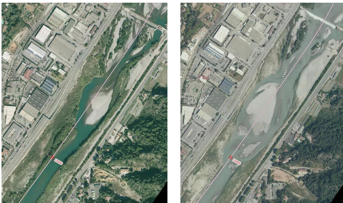
Figure 93 : Avancée des graviers et chasse des limons, par érosion latérale, en aval du seuil 8 entre 2012 (à gauche) et 2014 (à droite)
