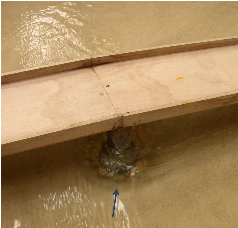
Figure 35 : Essai 3 du modèle physique à fonds mobiles de la trémie de la Manda (enlèvement du seuil provisoire) : attaque de la pile P2 en fin de crue centennale (source : /11/)
