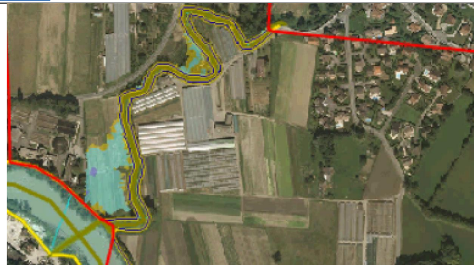
22. Premiers débordements du Foron en rive droite amont.
