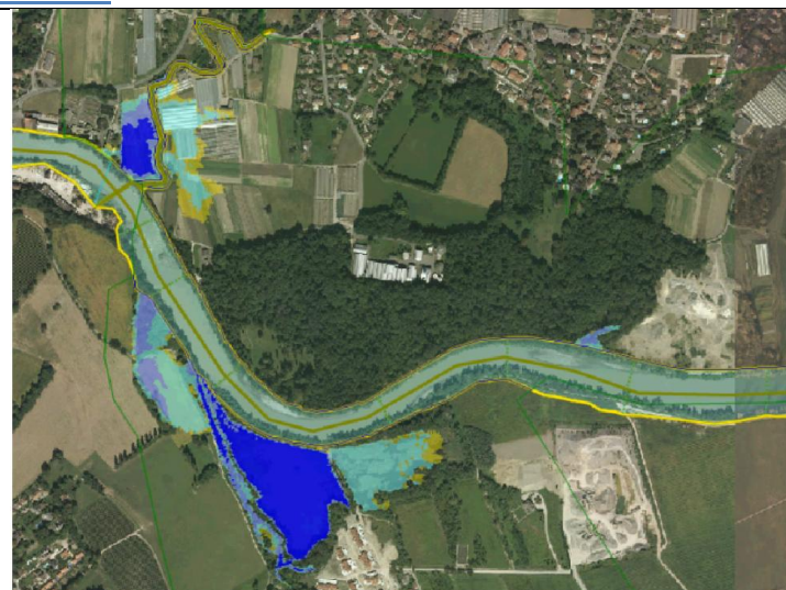
74. Premiers débordements de l'Arve en rive droite.
