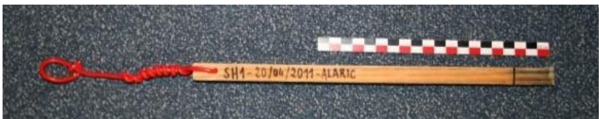
Figure 11 : stick hypoxique incubé, on remarque la partie grisée (hypoxie) délimitée par le trait noir en partie inférieure du tasseau.
