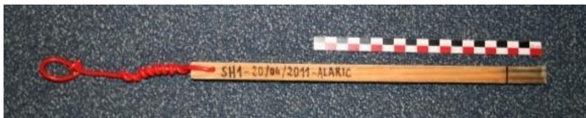
Figure 61 : stick hypoxique incubé, on remarque la partie grisée (hypoxie) délimitée par le trait noir en partie inférieure du tasseau.
