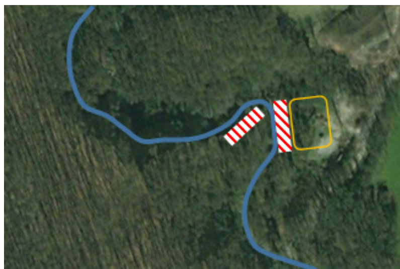
Erosions au niveau de la décharge (cours actuel de la rivière, pente de la décharge, zones d'érosion //.)
