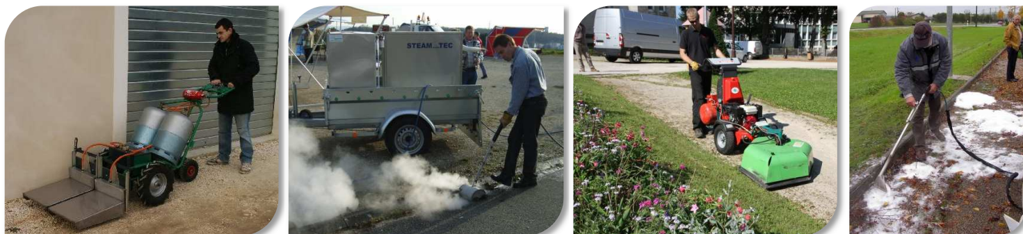
De gauche à droite : Désherbeur thermique à infrarouge, à vapeur, à air et à mousse chaude
