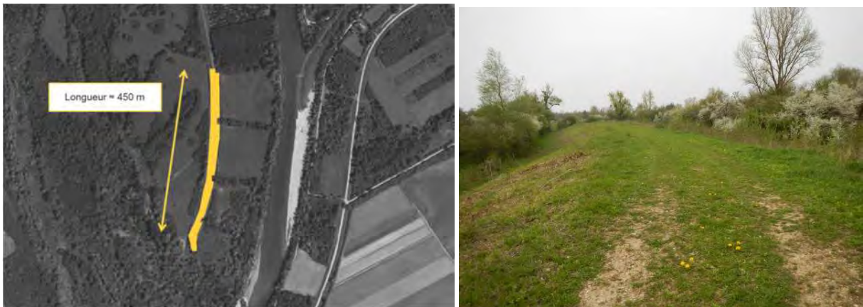
Fig. 24. Localisation de la portion de digue arasée
