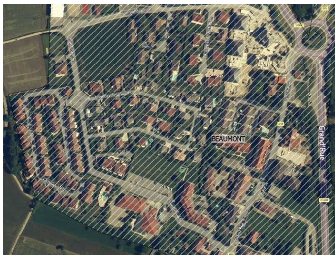
Figure 5 : Exemple de secteur pris en compte pour la détermination du coefficient d'imperméabilisation Ci = 0,8 \times 0,62 = 0,5
