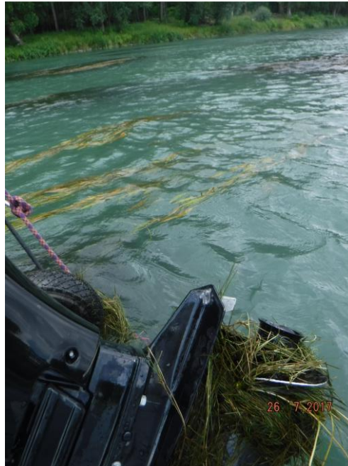
Figure 8 : Végétation aquatique prise dans l'hélice du moteur
