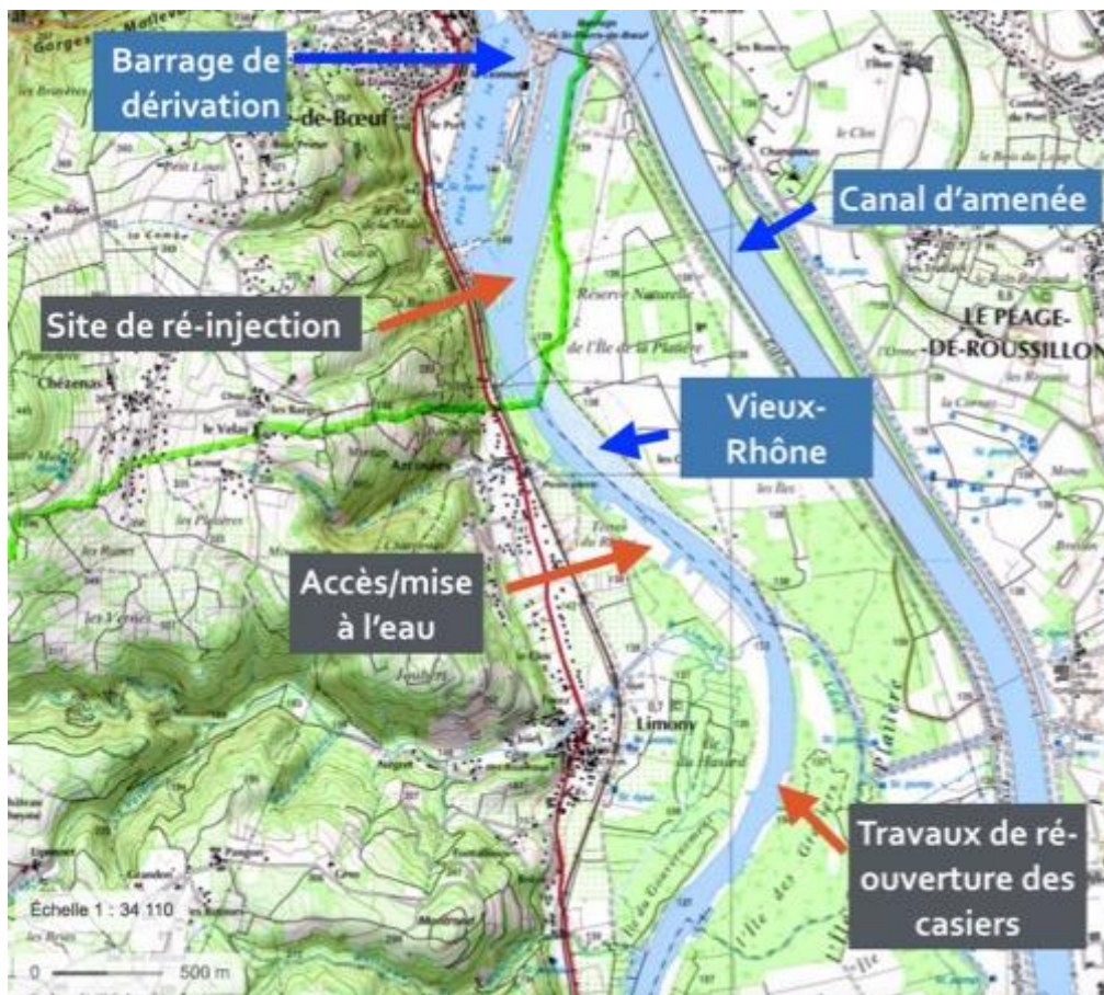
Figure 1 : Présentation générale de l'aménagement hydroélectrique de la plaine de Chautagne et banc de convexité où le suivi de placettes peintes est réalisé par la CNR (Source : fond cartographique : SCAN 25 –IGN Geoportail)
