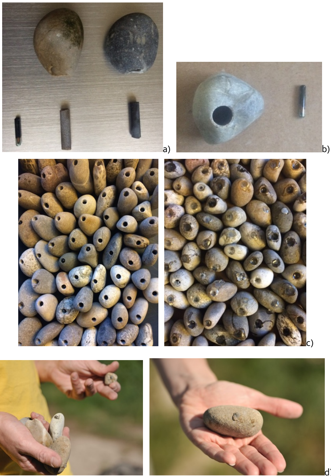
Figure 7 : Photographies : a) extraction de la mini-carotte après perçage en water-drilling ; b) exemple de petites particules forées (le transpondeur mesure 12 mm) ; c) particules forées et particules équipées de transpondeurs, scellés par de la résine ; d) exemple de traceurs prêts à être injectés (Sources : a)b)c) GeoPeka, d)Réserve de la Platière)
