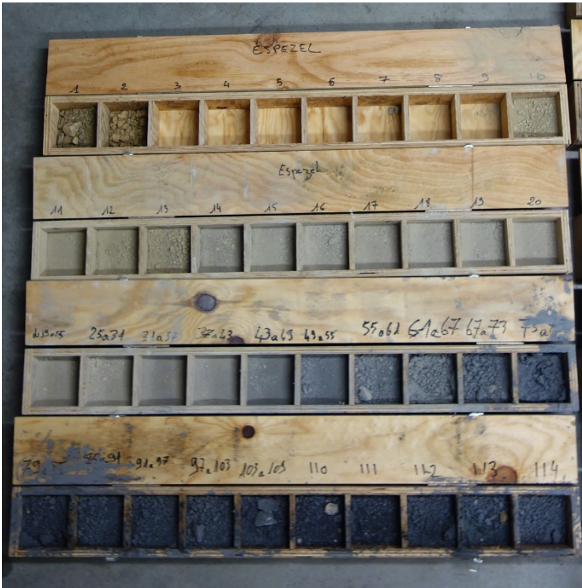
Figure 12 : Exemple de boîtes de cuttings récupérées par le foreur, ici de 0 à 114 mètres de profondeur, permettant la description géologique du forage. On observe les argiles des 2 premiers mètres, la cavité karstique et le passage des calcaires beige du Crétacé inférieur au calcaires noirs du Jurassique
