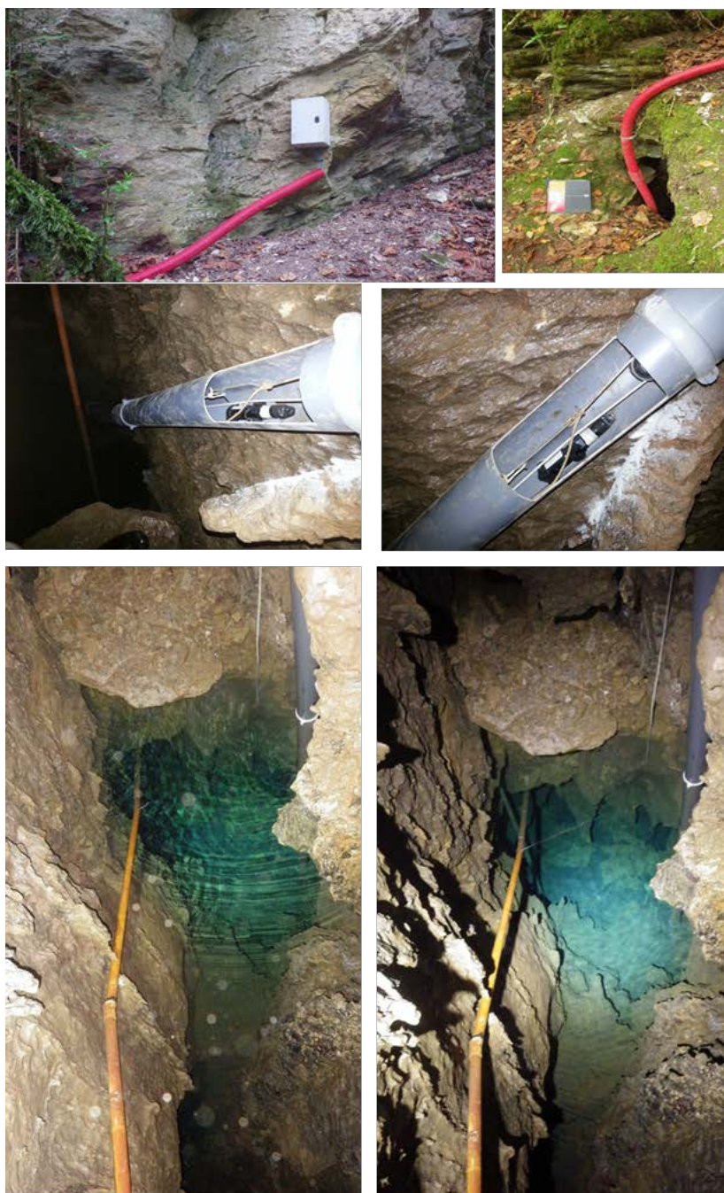
Figure 45. Vues de l'entrée du Barenc situé au dessus de la source des Adouxes (10882X0215/ADOUX) et vues partielles de l'équipement existant mis en place par le CD11 et du puits de mesure et équipement installés par Hydrogéosphère (tube gris) dans la cavité (Photos Hydrogéosphère).
