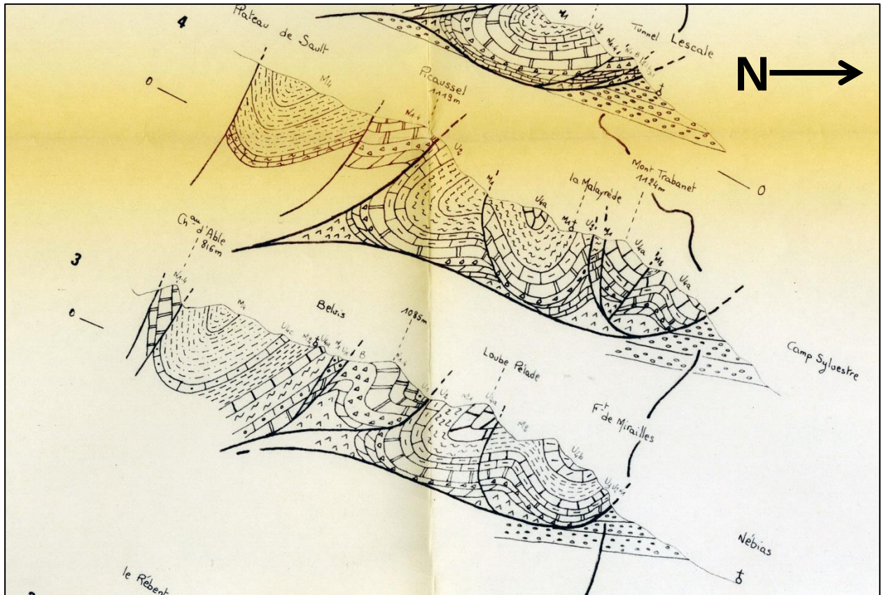
Illustration 30 : Structure du synclinal de Montmija d'après Bousquet (1975). Localisation des coupes sur l'illustration 28
