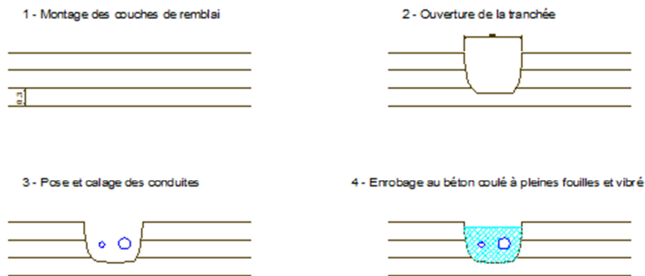
Figure 16 : Phase de la pose des ouvrages traversants
