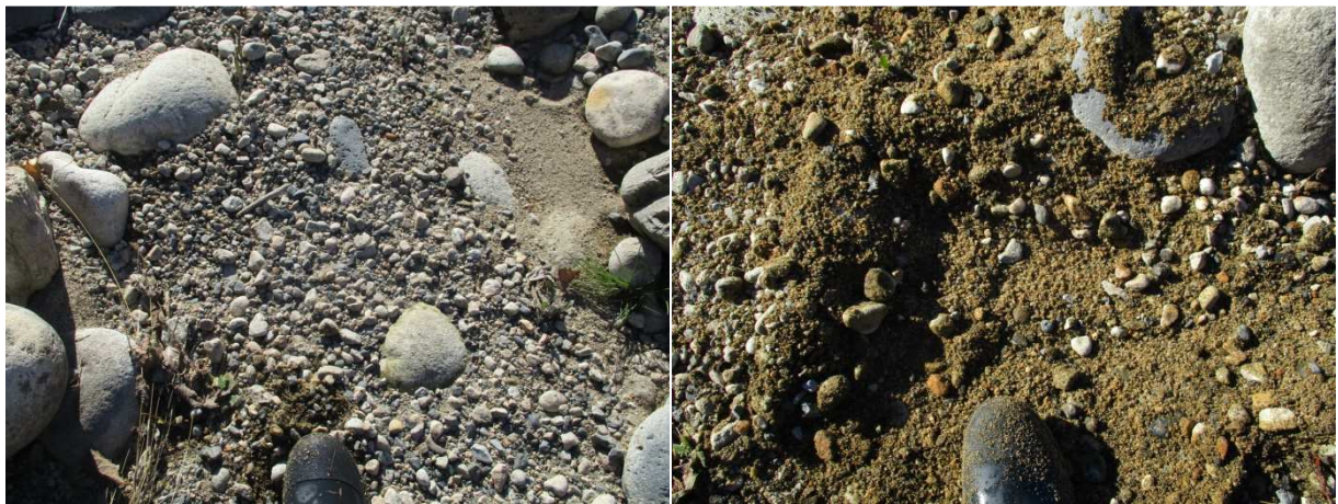
Figure 17 : Granulométrie de colmatage composée de sables et graviers (10 à 30 mm)
