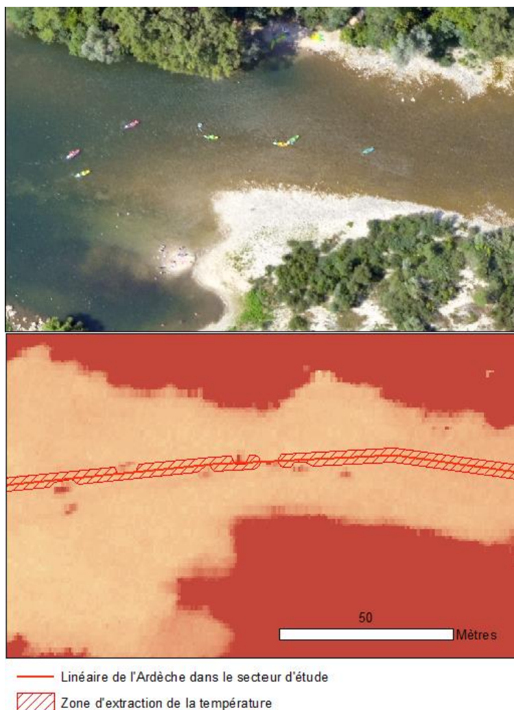
Figure 8: Illustration des corrections apportées aux zones d'extraction de la température sur les images thermiques. Image visible (en haut) et infra-rouge thermique (en bas) de la même zone.
