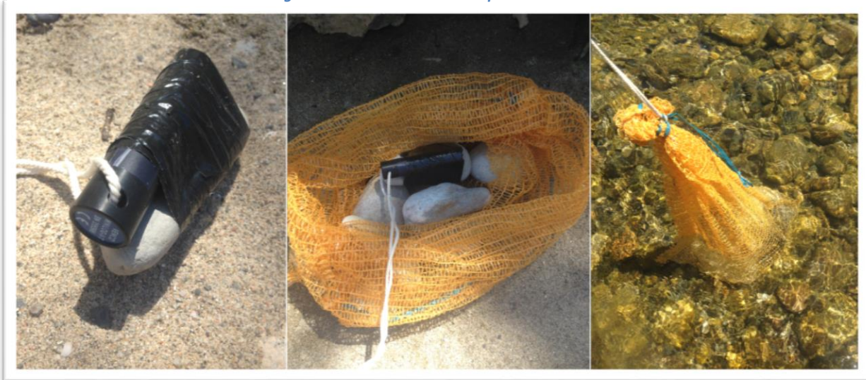
Figure 9 : Méthode de mise en place des sondes
