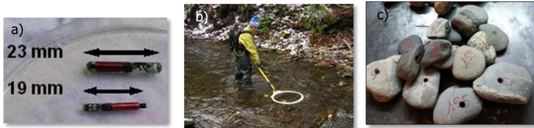
(a) Pit-tag de 23 et 19 mm, petite antenne de recherche (b) et (c) galets percés avant insertion d'un PIT-tag
