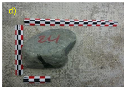
(a) Pit-tag de 32 mm, (b) Perçages carottés des matériaux à la colonne, (c-d) Insertions par collage des pit-tags dans les matériaux percés, numérotés et mesurés, (e) Lecteur pour l'insertion des pit-tags, (f) Prospection des matériaux à pied en rivière à l'aide d'une antenne circulaire (Source : HYDROGEOSPHERE)
