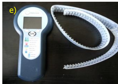
(a) Pit-tag de 32 mm, (b) Perçages carottés des matériaux à la colonne, (c-d) Insertions par collage des pit-tags dans les matériaux percés, numérotés et mesurés, (e) Lecteur pour l'insertion des pit-tags, (f) Prospection des matériaux à pied en rivière à l'aide d'une antenne circulaire (Source : HYDROGEOSPHERE)
