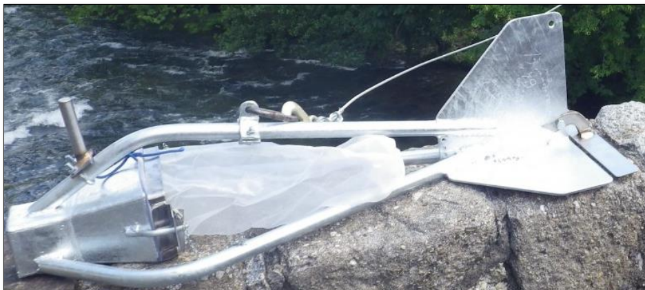
Préleveur Helley-Smith avant sa mise à l'eau
