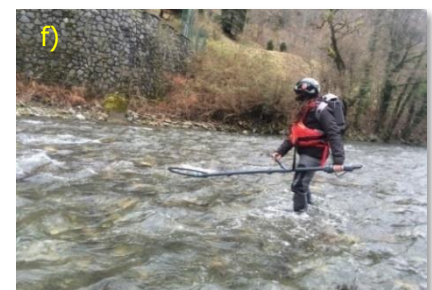
(a) Pit-tag de 32 mm, (b) Perçages carottés des matériaux à la colonne, (c-d) Insertions par collage des pit-tags dans les matériaux percés, numérotés et mesurés, (e) Lecteur pour l'insertion des pit-tags, (f) Prospection des matériaux à pied en rivière à l'aide d'une antenne circulaire (Source : HYDROGEOSPHERE)
