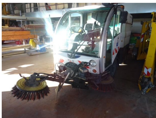
Balayeuse de voirie avec bras articulé ; Action préventive et curative de désherbage
