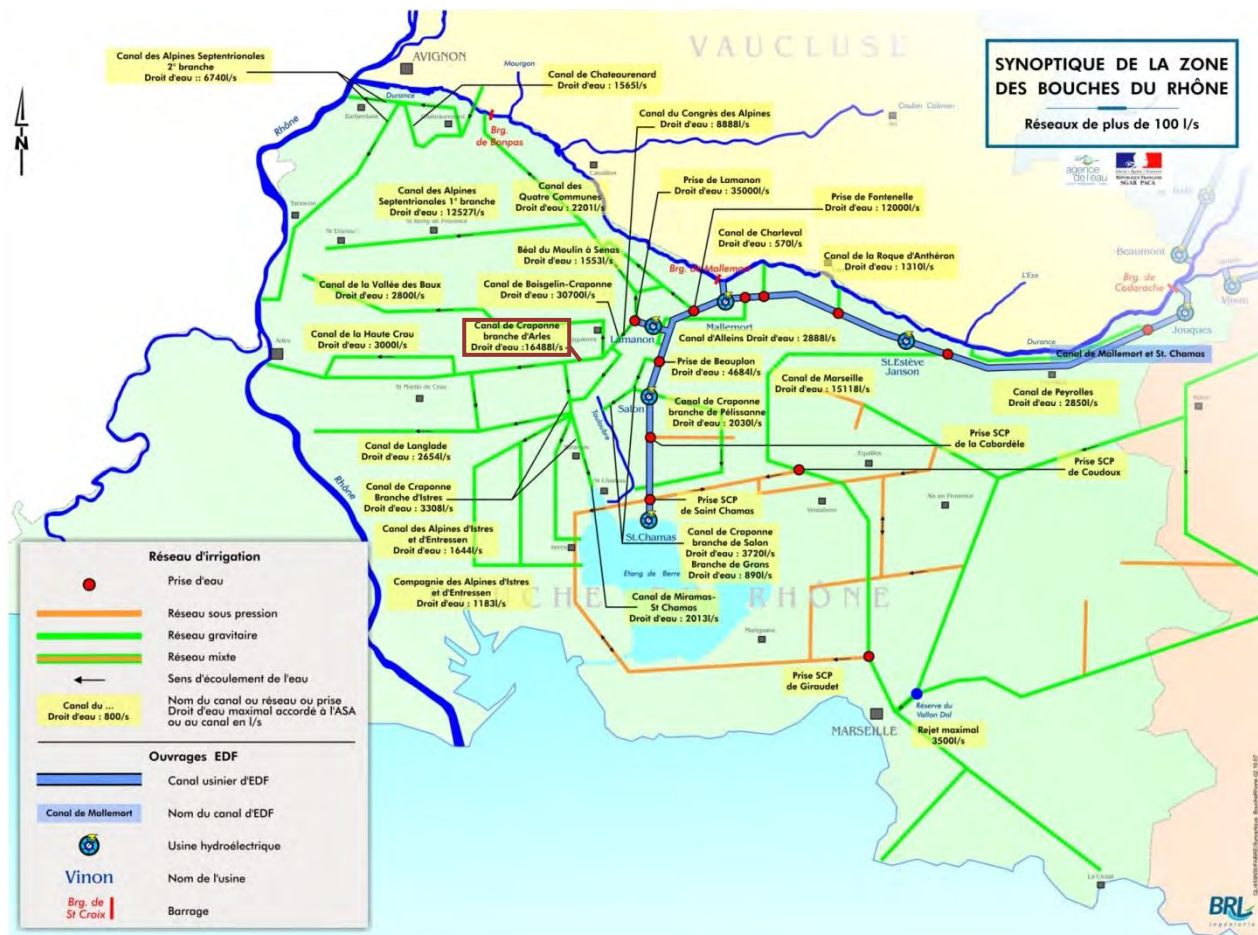
Figure 1-2 : Synoptique des grands ouvrages hydrauliques des Bouches du Rhône
