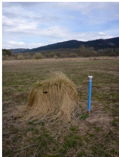
Piézomètre : zone aval du marais de vaux
