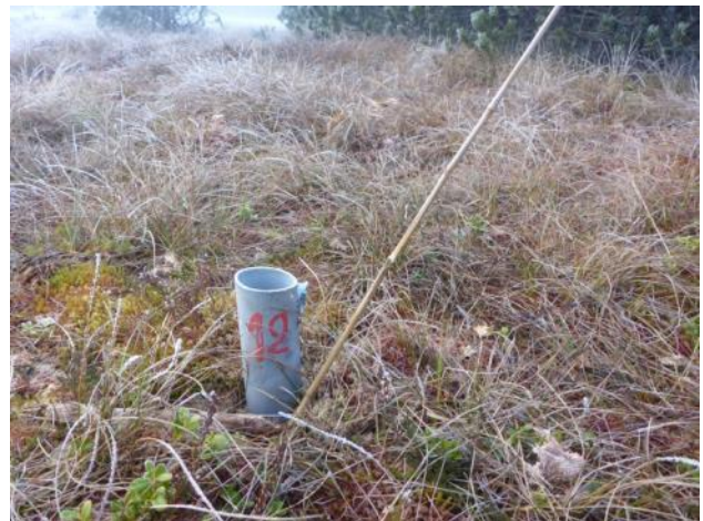
Piézomètre en aval de la tourbière du col (F. Paron)
