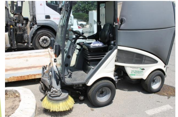
micro-balayeuse compacte de voirie avec capacité de stockage
