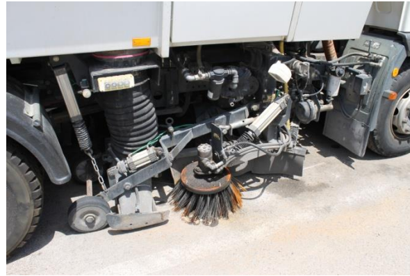
Balayeuse de voirie avec capacité de stockage
