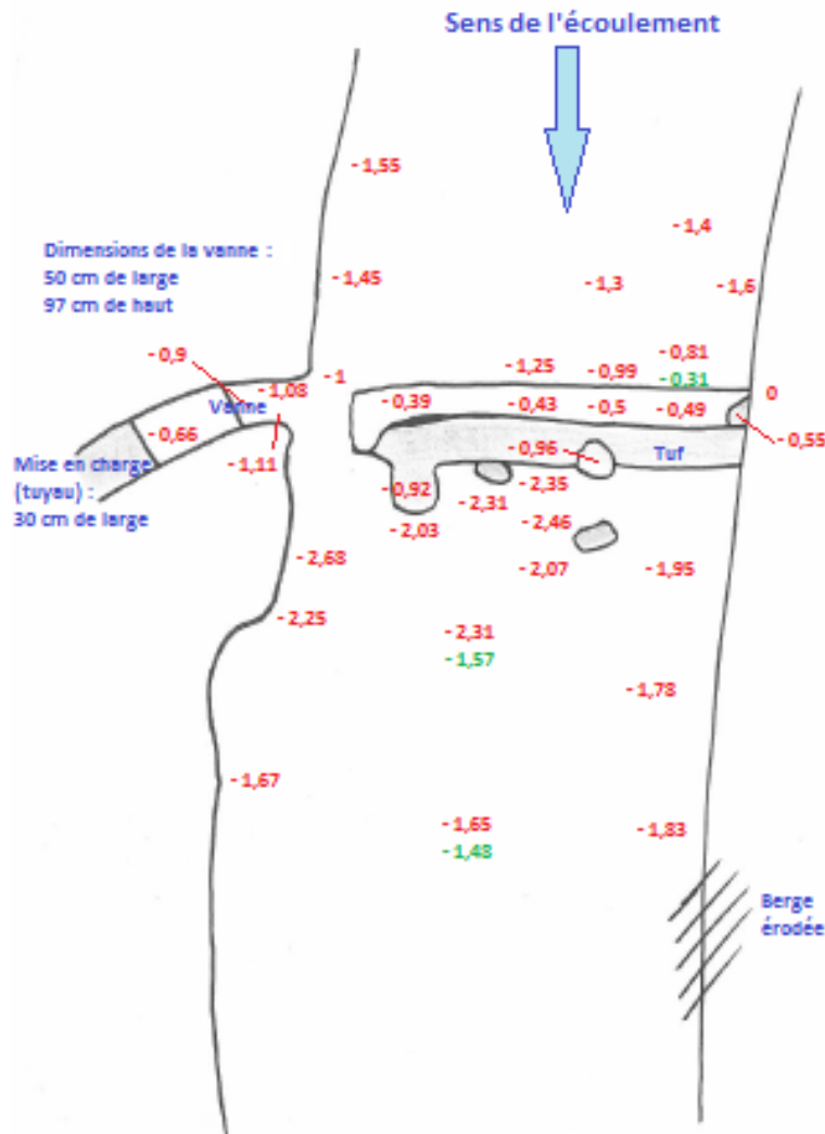
Figure 61 : Altitudes relevées aux abords du seuil du Plan, en relatif par rapport au point d'ancrage rive gauche de l'ouvrage (rouge : fond du lit, vert : ligne d'eau)
