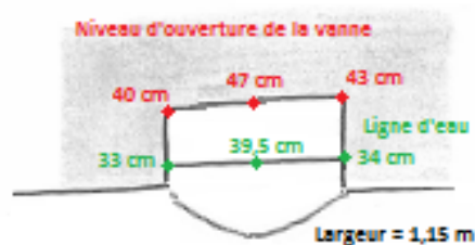
Figure 78 : Prise d'eau du canal présent en rive droite du seuil de Bégon
