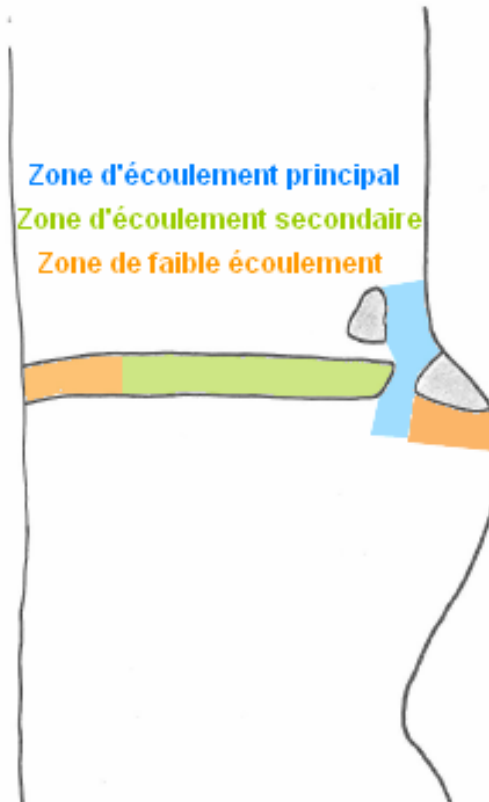
Figure 41 : Conditions hydrodynamiques au droit du seuil amont d'Entrecasteaux
